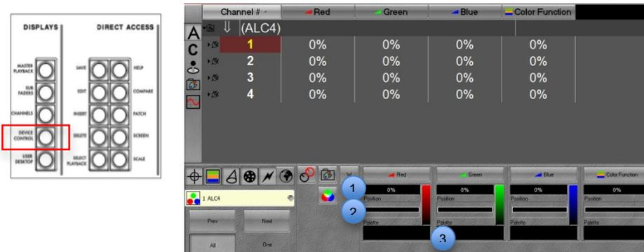
Sélectionner les Circuits correspondant à des projecteurs motorisés (numéros en vert). Sélectionner le groupe de Paramètres à contrôler soit avec une touche de la console (par ex.: [COLOR]) ou avec une touche tactile par ex.:
