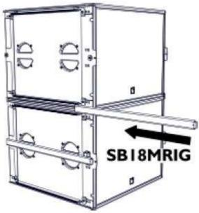
2° Verrouiller les rails en y insérant les loquets. Pour se faire, presser le ressort du loquet et le faire glisser de haut en bas jusqu'à ce qu'il s'enclenche.
