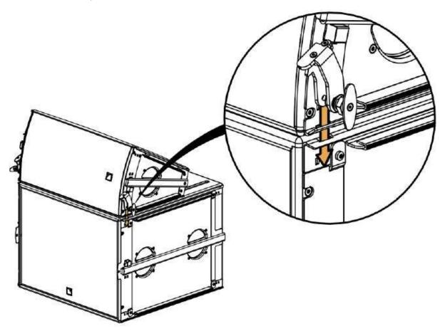
Une fois les verrous correctement installés, soulever l'arrière de l'enceinte Arcs focus et insérer le Wifotilt dans la platine du caisson SB18 :
