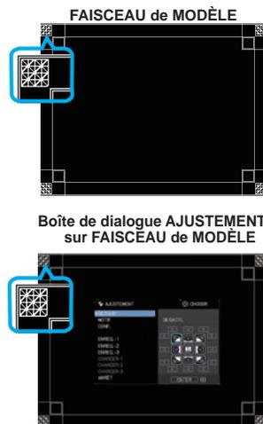
5. En utilisant AJUSTEMENT sur Appareil **B**, régler les dimensions de l'image et la position de Appareil **B** pour qu'elle se superpose correctement à celle de Appareil **A**. Il est recommandé de réaliser le réglage des manières suivantes.
